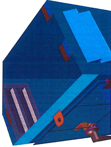
รายละเอียดตำแหน่งรางลิ้นยึดฝาบานแบบเลื่อน (ไม่แสดงฝาบาน)
